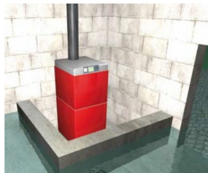
protection par disposition étanche
