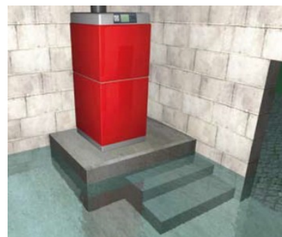
Mise hors d'eau par surélévation
